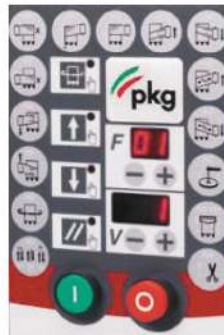
6 Programmi memorizzabili Tensionamento film: salita/discesa
