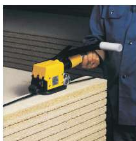
Pneumatica chiusura automatica misura reggia 19 - 25 - 32 mm
