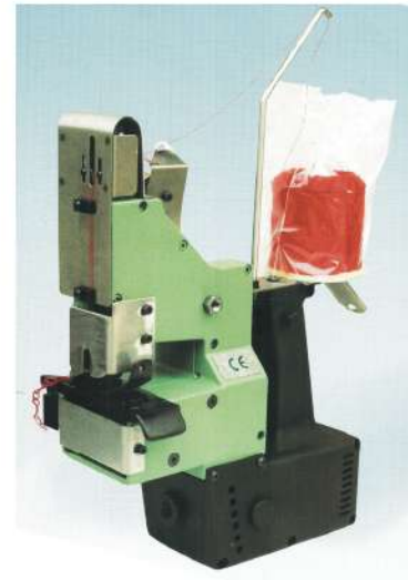
Macchina da cucire portatile per chiusura sacchi in diversi materiali
