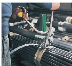
Tenditore + Pinza pneumatica misura reggia 19 - 32 mm
