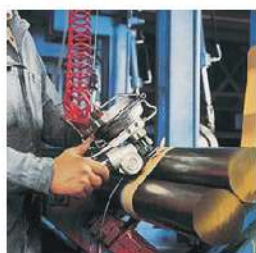
Tenditore + Pinza pneumatica misura reggia 19 - 32 mm
